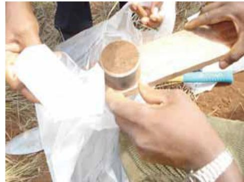
حينما يبلغ حجم عينة التربة 150 سم<sup>3</sup> يمكن حفظها كعينات تربة مركبة داخل أكياس بلاستيكية عليها ديباجة تسمية وإرسالها إلى المختبر لتحليلها. من كل مربع أخذ عينات ستكون هناك 3 عينات من التربة المركبة (أي من أعماق 0 - 10 و 10 - 20 و 20 - 30 سم).
