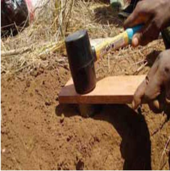
أ. يتم غرز/دفع اسطوانة أخذ العينات في التربة باستخدام مطرقة مطاوية. من المفيد تغطية الأسطوانة باستخدام لوح خشبي عند الدق/الطرق احرص بشدة على عدم دمك التربة، استخدم أسطوانة أساسية إضافية بين اللوح وأسطوانة العينة عند آخر بضعة سينتمترات لضمان أن تكون أسطوانة العينة تحت سطح الأرض تماماً ومليئة بالتربة غير المبعثرة.
