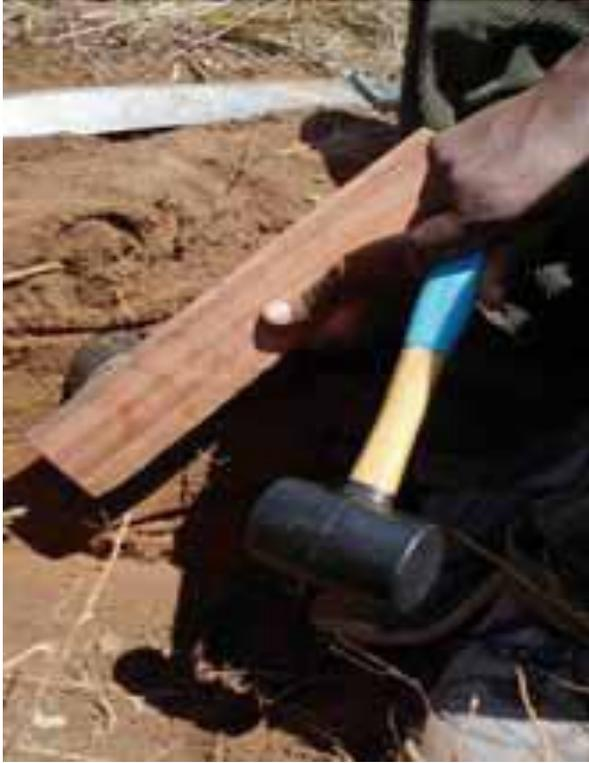
ب. يتم دفع أسطوانة أخذ العينات إلى جدار الحفرة باستخدام مطرقة مطاطية. من المفيد تغطية الأسطوانة باستخدام لوح خشبي عند الدق/الطرق. ملحوظة: احرص بشدة على عدم ضغط التربة - استخدم أسطوانة أساسية إضافية بين اللوح وأسطوانة العينة عند آخر بضعة سينتترات لضمان أن تكون أسطوانة العينة تحت سطح الأرض تماماً ومليئة بالتربة غير المبعثرة.
