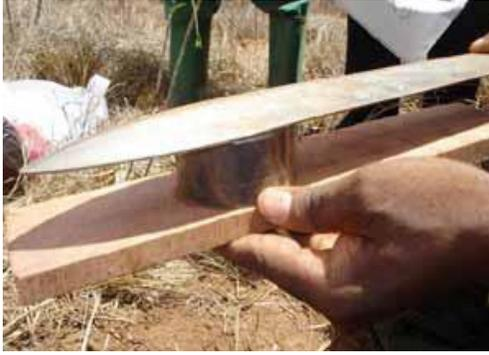
ضع لوح خشبي فوق عينة التربة المسطحة ثم امسكها واقلبها بسرعة للحيلولة دون تناثر التربة من الأسطوانة
